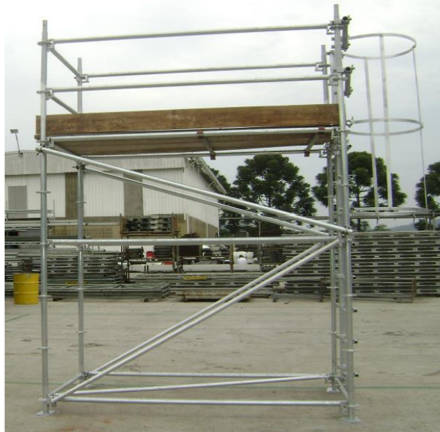
FIGURA 2 – andaime tubular de encaixe simplesmente apoiado
